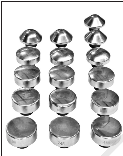
16 x Steel Lower Dies 3/4", 1", 1-1/8", 1-1/2", 1-7/8", 2", 3", 4", 5", 6", 8", 14-1/2", 24", 36" Radius (Ø30 x 20mm round shanks)
